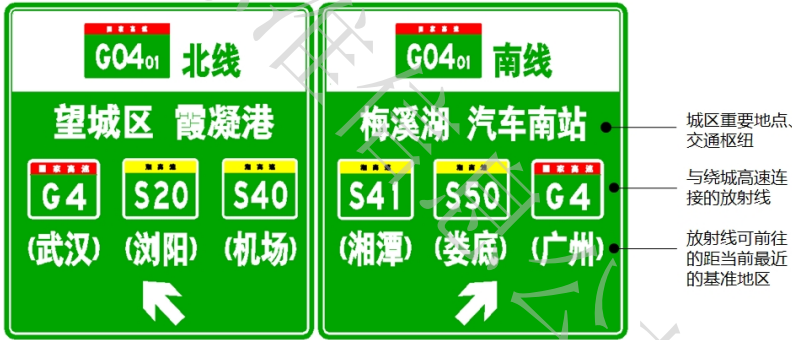
图 32 绕城高速公路地点、方向标志示例
